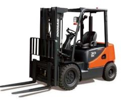
D20S / D25S / D30S / D33S-5 & D35C-5 G20E / G25E / G30E-5 G20P / G25P / G30P / G33P-5 & G35C-5 2,000kg 2,500kg 3,000kg 3,300kg 3,500kg Diesel, LP, Pneumatic Tire
